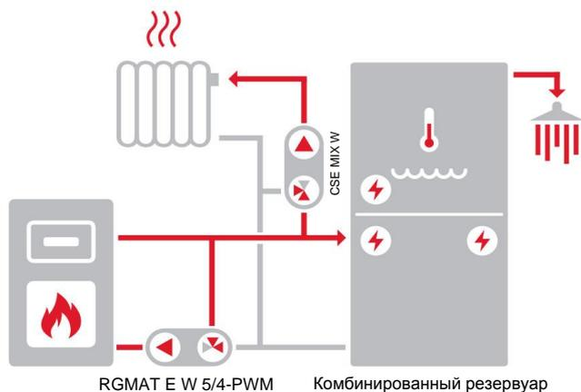
На схеме показано типичное подключение твердотопливного котла, комбинированного резервуара и отопительного контура (с рекомендуемой насосной станцией CSE MIX W - не входит в комплект поставки).
