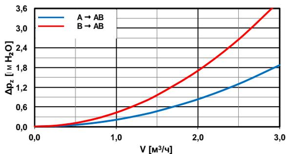
Значение перепада давления перемещается между двумя кривыми в зависимости от соотношения смешивания во время смешивания
