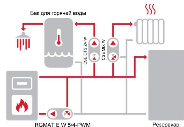
На схеме показано типичное подключение твердотопливного котла, резервуара и отопительного контура (с рекомендуемой насосной станцией CSE MIX W - не входит в комплект поставки). Если котел используется также для обогрева горячей воды, рекомендуется установить насосную станцию CSE OTS ZV W (не входит в комплект поставки).
