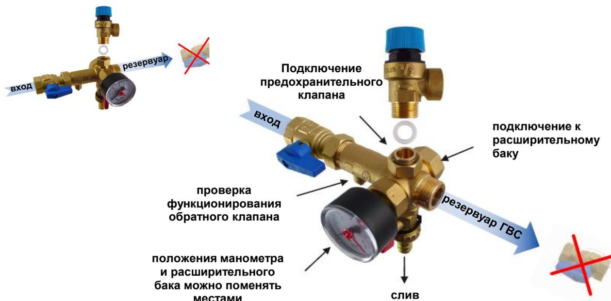
**Комплект безопасности для резервуаров хранения горячей воды**
