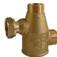
Ladeventil mit automatischem Bypass Abgleich, mit 1" AG Gewinde an den Einlässen (Anschluss A und B) und einer 1" IG Überwurfmutter am Auslass (Anschluss AB). Die Überwurfmutter ermöglicht eine direkte Verbindung mit einer Umwälzpumpe mit 1" Anschlussgewinde.
