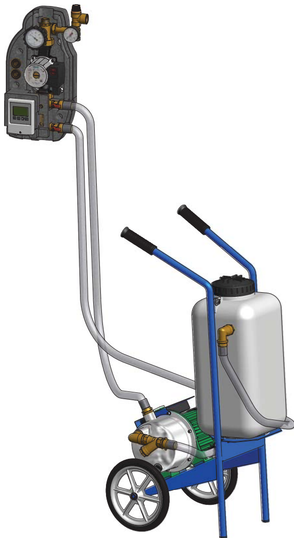
Obr. 33: Plnenie solárneho systému
