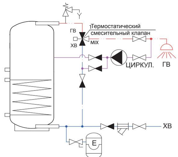
Регулируемая температура с помощью регулятора (с параметрами  $T_H = 65\text{ °С}$ ,  $T_C = 15\text{ °С}$ ,  $p = 3\text{ бар}$ ):
