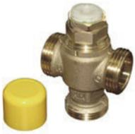
Термостатический смесительный клапан ГВС для солнечных систем, внешняя резьба для прокладки, шестигранный ключ, регулируемый на 30-65 °С.
