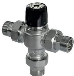
Термостатический смесительный клапан ГВС, внешняя резьба с муфтой, обратный клапан и грязеуловитель, ручка регулируется на 30-65 °С.
