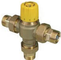
Термостатический смесительный клапан ГВС для гелиосистем, внешняя резьба с муфтой, обратный клапан и грязеуловитель, ручка регулируется на 30-65 °С
