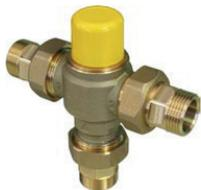
Термостатический смесительный клапан ГВС для геосистем, внешняя резьба с муфтой, обратный клапан и грязеуловитель, шестигранный ключ, регулируемый на 30-65 °С.
