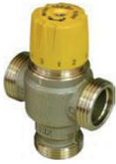
Термостатический смесительный клапан ГВС для солнечных систем, внешняя резьба с прокладкой, ручка регулируется на 30-65 °С
