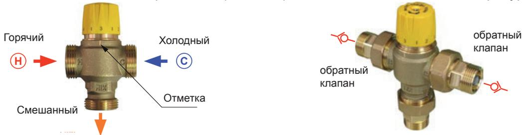
Кроме того, клапан имеет функцию защиты от ожогов. В случае перебоя в подаче холодной воды прерывается и подача горячей воды. Эта защитная функция работает от перепада температур 10 К между поступающей ГВС и смешанной горячей водой. Ее функциональность можно проверить, закрыв холодное водоснабжение; поток через термостатический клапан должен очень быстро упасть до нуля.
