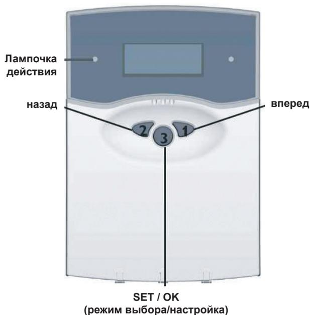
1. Сначала прибор включим в сеть. Следует пусковой этап, во время которого контрольная лампочка мигает зеленым и красным светом. После завершения пускового этапа регулятор переходит в автоматический режим с заводской настройкой. Схема, введенная заводом, отвечает солнечной системе на рис. Arr 1.
