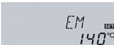
При превышении заданной критической температуры коллектора (**EM/EM1/EM2**) выключится соляренный насос (R1/R2), для предупреждения повреждения компонентов соляренной системы из-за перегрева (Аварийное выключение коллектора). На дисплее появится мигающий знак
