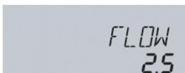
Протекающий объем в солнечной системе измеряется при помощи V40 для определения теплопередачи.
