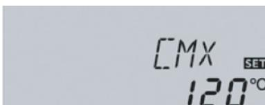
Когда температура резервуара дойдет до максимальной, соляренная система выключится. Если после этого температура коллектора поднимется до заданной макс. температуры коллектора (**CMX / CMX1 / CMX2**), соляренный насос остается в действии, пока температура не понизится под это значение. Несмотря на это температура в резервуаре может возрасти (подчиненная максимальная температура резервуара), но только до 95 °C (Аварийное выключение резервуара).
