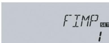
Начитанное количество можно обнулять. При выборе канала кол-ва тепла на дисплее включается SET. Нажимая на кнопку SET (3) в течение 2 сек., вызываем режим обнуления счетчика. Символ SET мигает и счетчик обнуляется. Для завершения этой процедуры надо снова нажать на SET для подтверждения. Если кнопку SET не держать нажатой 5 сек., процедура обнуления прерывается. Регулятор вернется в стандартный режим изображения.
