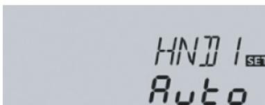
Для проведения сервисных или контрольных работ можно вручную задавать режим работы регулятора. Для этого выбираем параметр MM, который позволит провести следующую настройку:
