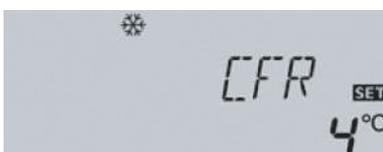
Функцию защиты от замерзания приводит в активность питающий контур между коллектором и резервуаром тогда, когда температура понижается под заданную величину, чтобы теплоносная жидкость не замерзла или не погустела. Если температура на 1°C превысит заданную величину, контур выключится.
