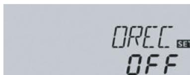
Когда температура резервуара дойдет до максимальной (**S MX**, **S1MX**, **S2MX**), солянный насос остается в действии, чтобы не допустить перегрев коллектора. Температура в резервуаре может возрасти, но только до 95 °C (Аварийное выключение коллектора). Вечером система продолжает действовать, пока резервуар при помощи коллекторов и труб не остынет до своей заданной максимальной температуры.
