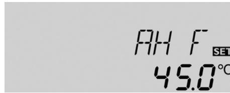
**AH F:** Выключающая температура термостата
