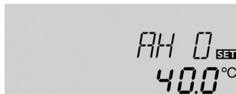
**AH O:** Включающая температура термостата
