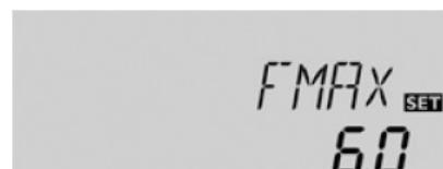
Величину протекаемого объема, прочитанную на расходомере (л/мин.), надо настроить параметром **FMAX**. Тип незамерзающей жидкости и ее концентрация изображаются параметрами **MEDT** и **MED%**.
