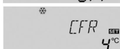
Функцию защиты от замерзания приводят в активность питающий контур между коллектором и резервуаром тогда, когда температура понижается под заданную величину, что теплоносная жидкость не замерзла или не погустела. Если температура на 1°C превысит заданную величину, контур выключится.
