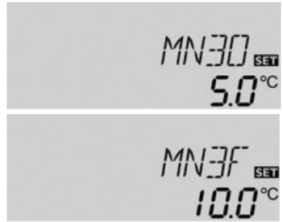
Регулятор оснащен независимой регуляцией температурного дифференциала, где можно отдельно задать ограничение максимальной и минимальной температур, также, как соответствующие переключающую и выключающую температуры. Функция доступна только для Arr=2 и 8 (т.е. для котла на твердое топливо и с доп. нагревом котлом на твердое топливо).
