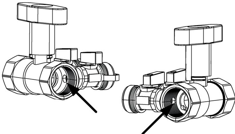
**ОСТОРОЖНО:** Прикрутите трубы к клапану не более чем на 15 мм, чтобы избежать засорения боковых путей к заправочным/сливным кранам. Обратный клапан должен быть установлен на обратной линии солнечного контура.
