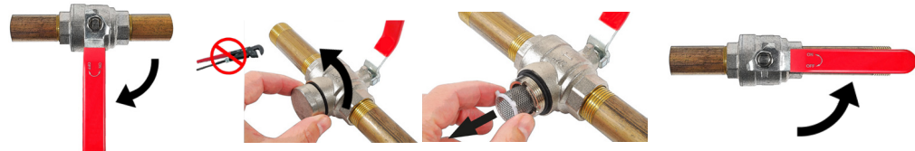
Obr. 6 - uzatvorenie ventilu Obr. 7 - vybratie filtračného sítka Obr. 8 - otvorenie ventilu
