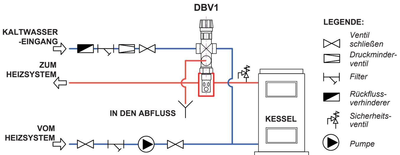
Abb. 3: Schema des DBV1-Ventileinbaus in die Heizungsanlage
