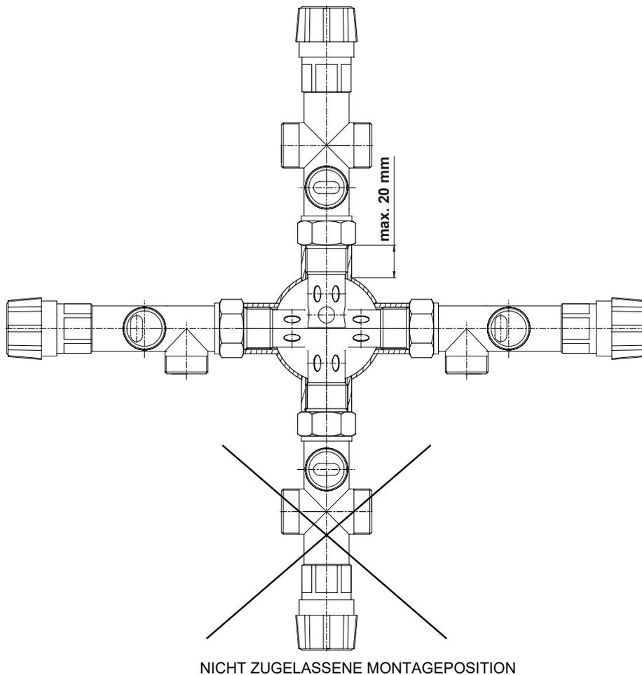
Das Zwei-Wege-Nachkühlthermostatventil kann sowohl vertikal als auch horizontal montiert werden. In horizontaler Position muss der Heißwasserauslass "C" (Abb. 1 und 2) vom Kessel so platziert werden, dass er nach unten zum Boden zeigt. Das Zwei-Wege-Nachkühlthermostatventil darf nicht nach unten montiert werden!
