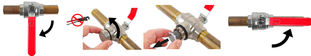
Obr. 6 - uzavření kohoutu Obr. 7 - vyjmutí filtračního sítky Obr. 8 - otevření kohoutu
