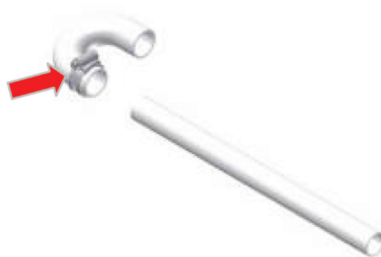
Obr. 14: Montáž hadice na kondenzát ve tvaru U
