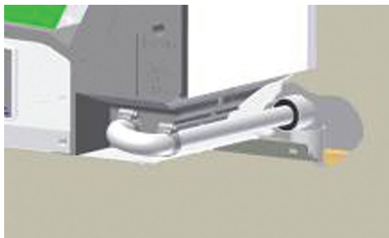
Obr. 15: Připojení trubky 22 mm na odpad
