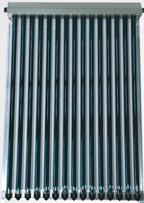
Trubicový vakuový kolektor s výkonem 1090 W (při osvitu 1000 W/m<sup>2</sup>) určený k vertikální montáži nad střešní krytinu. Trubice je tvořena dvěma skleněnými souosými trubkami, mezi kterými je vakuum. Ke skleněné trubici přiléhá hliníková lamela, která sbírá teplo z celého vnitřního povrchu vakuové trubice a předává ho do solární kapaliny v měděné trubičce. Měděné trubičky se spojují v rozdělovači kolektoru izolovaném 30 mm vrstvou minerální vlny.
