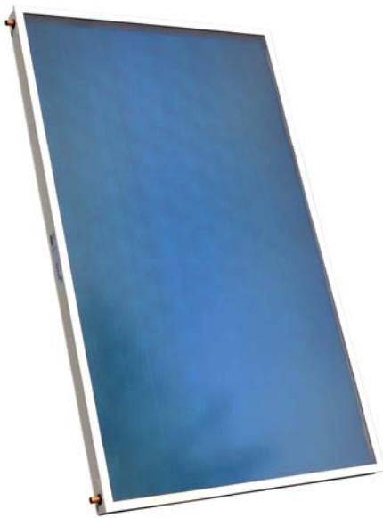
Plochý kolektor s výkonem 1802 W (při osvitu 1000 W/m<sup>2</sup>) určený k vertikální montáži (na stojato) nad střešní krytinu. Lyrový absorbér s vysoce selektivním povrchem TiNOx je spojen s měděným potrubím technologií laserového svařování. Izolaci tvoří 40mm vrstva minerální vlny. Připojení je umístěno nahore a dole po stranách.
