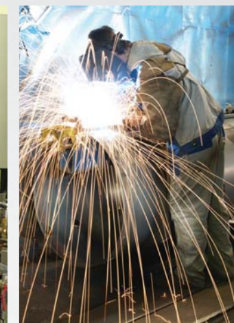
Výroba akumulčních nádrží v Prešově
