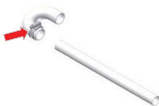
Obr. 14: Montáž hadice na kondenzát v tvare U
