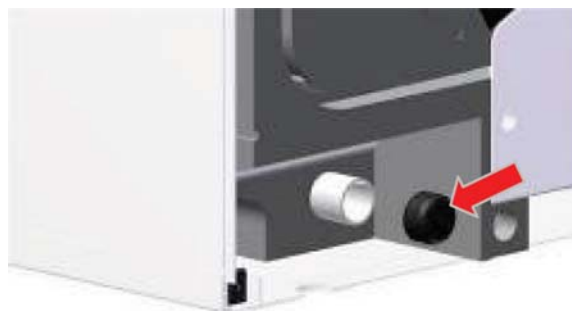
Obr. 8: Odstránenie záslepky z vývodu kondenzátu (zadná strana)
