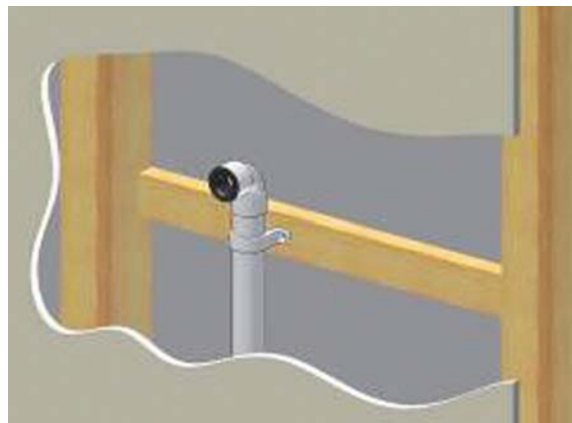
Obr. 13: Príprava pripojenia odvodu kondenzátu na zvislý odpad
