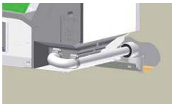
Obr. 15: Pripojenie rúrky 22 mm na odpad
