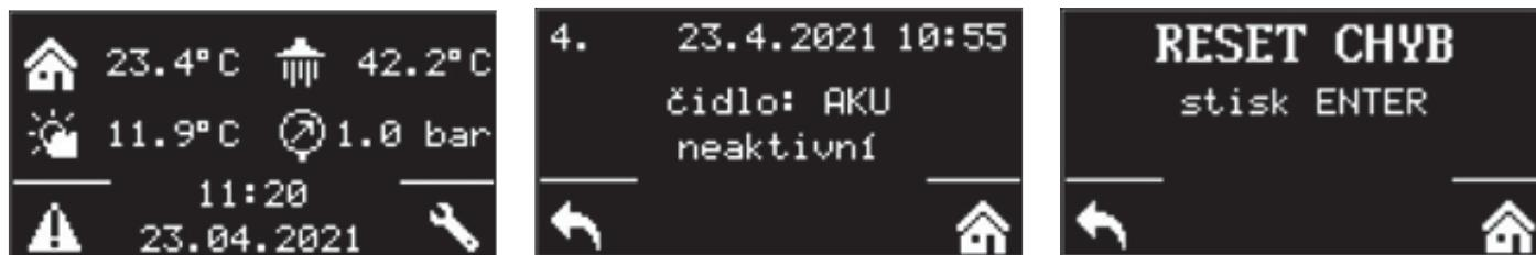
Po stisku tlačítka pod vykřičníkem se zobrazí poruchy v tomto pořadí: na 1. až 3. místě poruchy tepelného čerpadla a na 4. až 5. místě ostatní poruchy. Na šesté pozici je pak obrazovka pro resetování chyb tepelného čerpadla.
