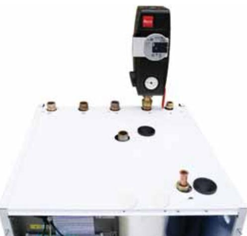
2 - na nátrubek 6 (G 1" M) namontujte bezpečnostní skupinu otopného systému s T-kusem a ventilem G 1/2", odpad z pojistného ventilu napojte na vypouštěcí nálevku zamontovanou ve víku RegulusHBOXu. Bezpečnostní skupina obsahuje pojistný ventil, odvzdušňovací ventil a tlakoměr. Ventil G 1/2" slouží k dopouštění otopného systému.
