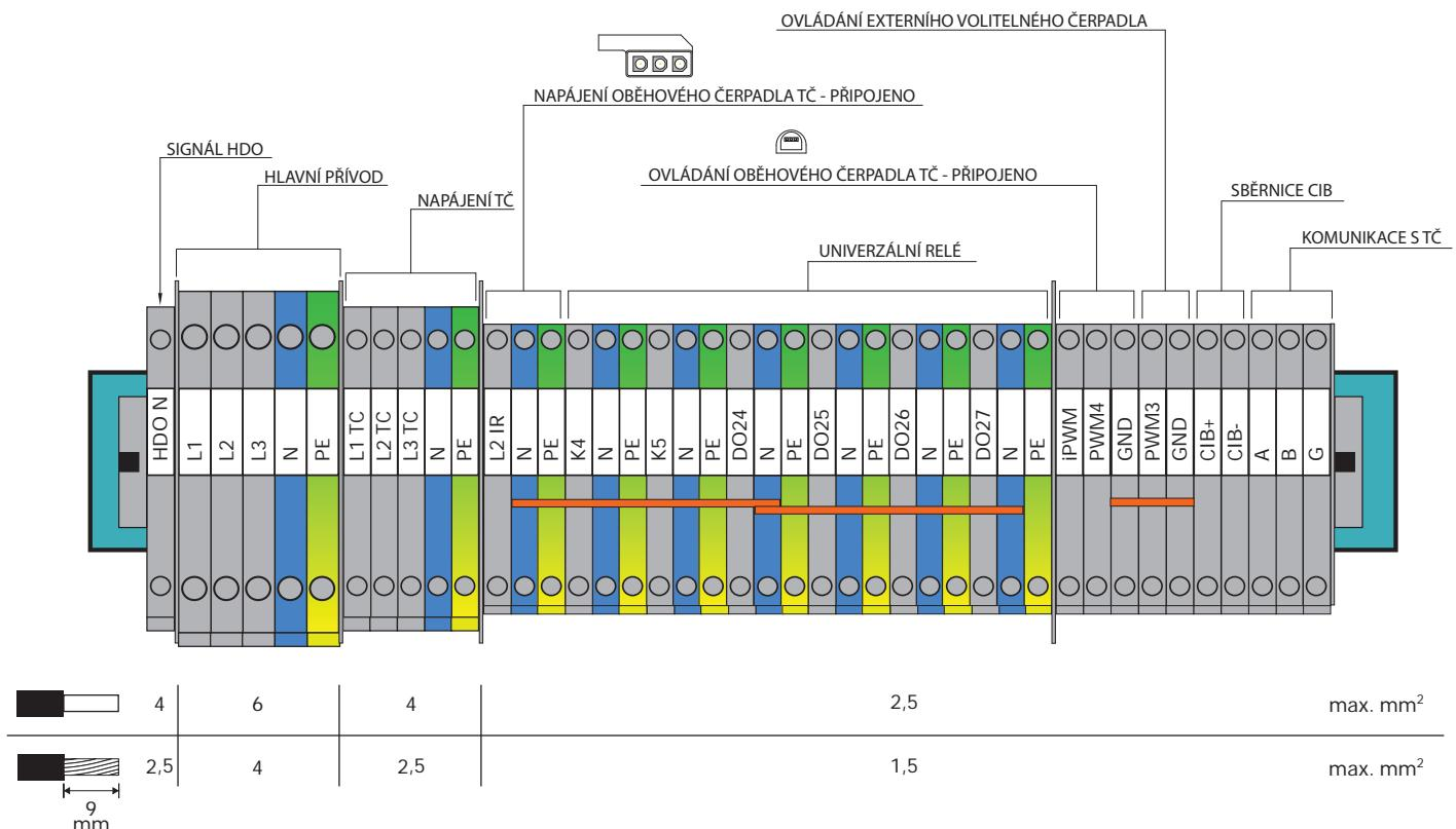
Univerzální výstupy K4, K5 a DO24-DO27 nemají továrně přiřazenou žádnou funkci. Zařízení spínané z těchto výstupů je nutné nastavit v servisním rozhraní regulátoru.
