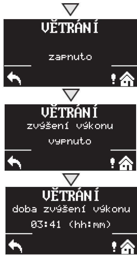
Větrání můžete zapnout nebo vypnout.
