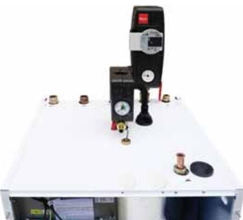
3 - na trubku 7 (Cu 18mm s převlečnou maticí G 3/4") namontujte pojistnou sadu SV, odpad z pojistného ventilu napojte na vypouštěcí nálevku zamontovanou ve víku RegulusHBOXu. Pojistná sada obsahuje uzavírací ventil, zpětný ventil s kontrolním ventilem, pojistný ventil, tlakoměr a vypouštěcí ventil G 1/2" s jehož pomocí lze zároveň dopouštět otopný systém.
