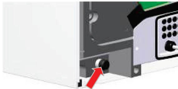
Obr. 7: Záslepka vývodu kondenzátu (zadní strana)
