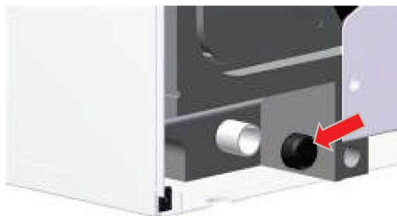
Obr. 8: Odstranění záslepky z vývodu kondenzátu (zadní strana)
