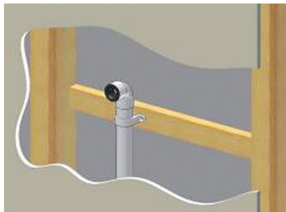
Obr. 13: Příprava připojení odvodu kondenzátu na svislý odpad
