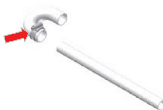
Obr. 14: Montáž hadice na kondenzát ve tvaru U
