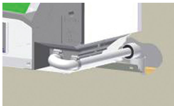
Obr. 15: Připojení trubky 22 mm na odpad
